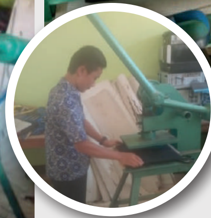
Gambar 20. Cara kerja mesin press dan pisau pon
