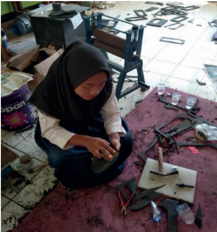
Gambar 23. Proses pengeleman insol dan outsole
