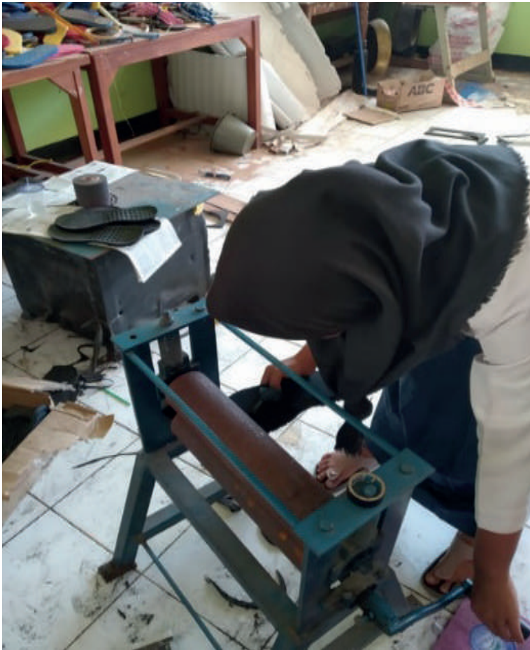
Gambar 24. Proses pressing sandal gunung
