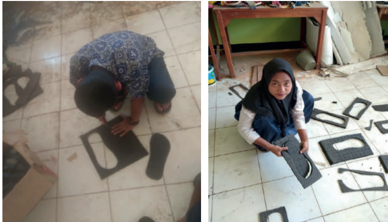
Gambar 21. Hasil pemotonganspongemenggunakan mesin press dan pisau pon
